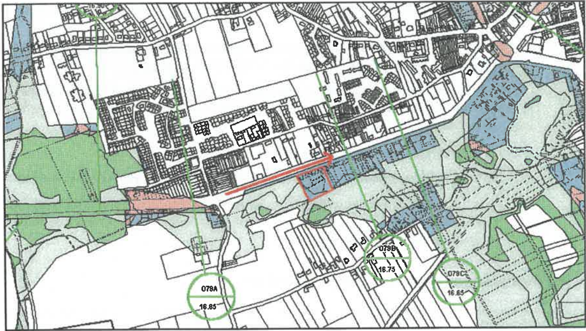
Schéma de principe de définition de la cote de crue centennale au droit de la parcelle aménageable cerclée de rouge (ici, 16.85m, la flèche rouge indiquant le sens d'écoulement du cours d'eau)
